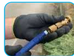
Inserimento nuova guarnizione
